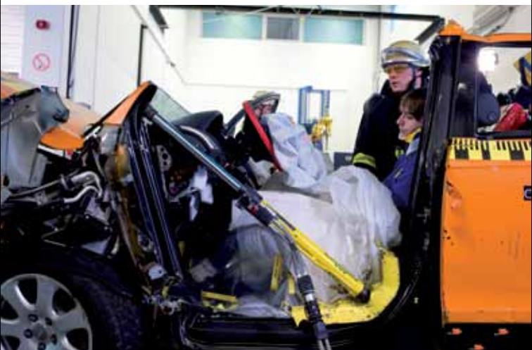
5. Erweitern des Fußraums durch Rettungszyylinder
