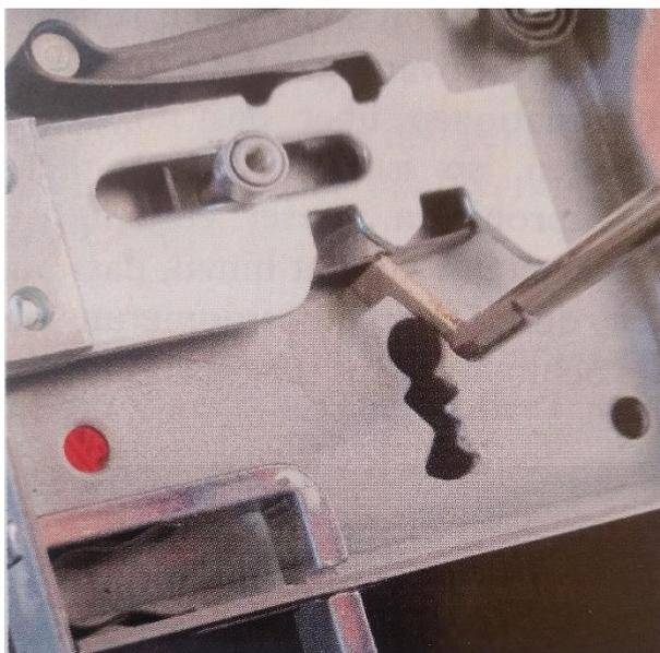
Sperrhaken durch das Schlüsselschaftloch in das Schloss einführen. Riegelsperre (Sicherung) hochheben. Mitnehmer nach hinten ziehen.
