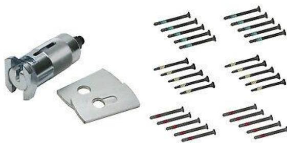
Eine Ziehglocke besteht aus der eigentlichen Glocke, die über den Schliesszylinder gestülpt wird, sowie dem inneren Zugbolzen, der zur Aufnahme der Zugschraube und damit zum Herausziehen des Kerns bzw. zum Brechen des Zylinders dient. Darüber hinaus wird zum Ziehen des Kerns eine spezielle Kernziehplatte benötigt. Dazu ist jeweils eine Kernziehplatte für Profilzylinder und eine Kernziehplatte für Rundzylinder vorhanden.
