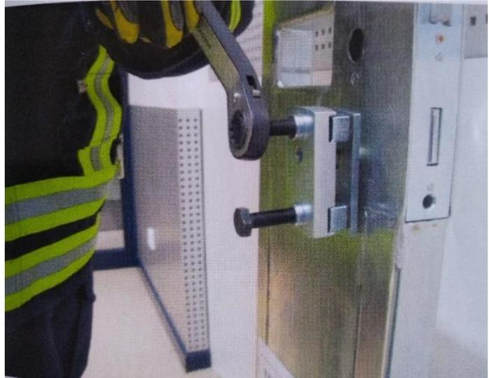
Zum Ziehen des Kerns erfolgt wiederum das Einschrauben der Zugschraube gemeinsam mit der Druckplatte. In diesem Fall muss
