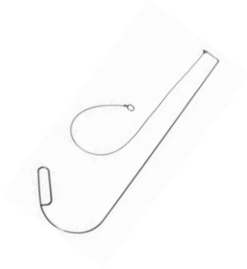
Bei der Türklinkenangel handelt es sich um einen einer Angel ähnlich geformten Drahtbügel mit vorne angebrachtem Zugseil. Der Drahtbügel ist dazu geeignet das Zugseil unter der Tür hindurchzuführen und es dann auf der abgewandten Seite über die Türklinke zu werfen. Für Norm Klinken von 105 cm höhe.
