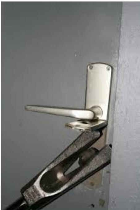
Das Schliessblech entfernen. Den Schliesszylinder zwischen die Schenkel der klau führen und durch Drehen des Tools abscheren. Zweite Hälfte des Zylinders herausschlagen. Mit einem entsprechenden Schlüssel ist es nun möglich, die Tür aufzuschliessen.
