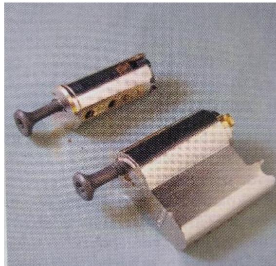
Figure 21 Zylinder gebrochen
