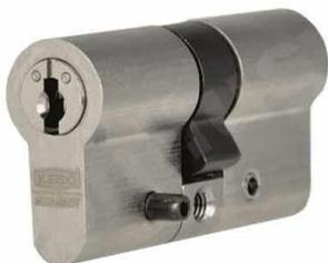
Schliesszylinder mit verstärkter Stahleinlage. Diese Stahlschiene verleiht dem Zylinder in dem besonders schwachen Querschnitt die notwendige Festigkeit, so dass ein Ausbrechen des Schliesszylinders unmöglich ist.
