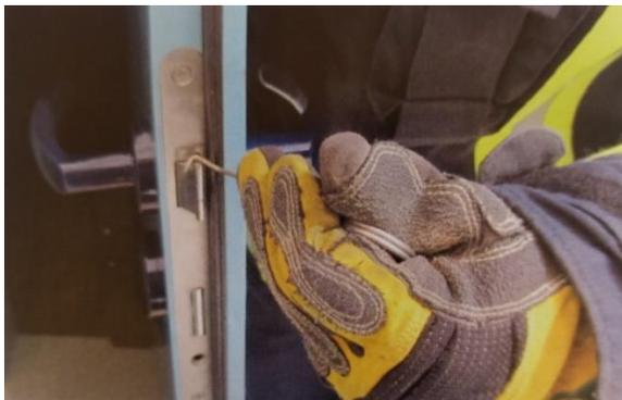
Falle über die schräge Seite in den Schlosskasten zurückdrücken und die Tür öffnet sich.
