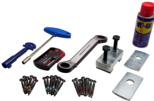
Das Zieh-Fix-Gerät dient sowohl zum Ziehen des Kerns wie auch zum Brechen des Steges von Profilzylindern und Rundzylindern. Im Wesentlichen besteht das Werkzeug aus den eigentlichen Zugwerkzeug in Form einer Metallpalette mit einer Bohrung zur Aufnahme der Zugschraube sowie zwei Andruckschrauben. Mit zum Lieferumfang gehört eine Kernziehplatte für Profilzylinder und eine Kernziehplatte für Rundzylinder.
