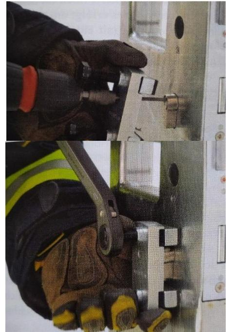
Nach dem Brechen des Zylinders, müssen noch die Verbleibende Teile entfernt werden. Dies erfolgt durch Herausstossen der hinteren Zylinderhälfte. Der verbleibende Betätigungshebel muss ebenfalls mit einer Spitzzange aus dem Schloss entfernt werden.
