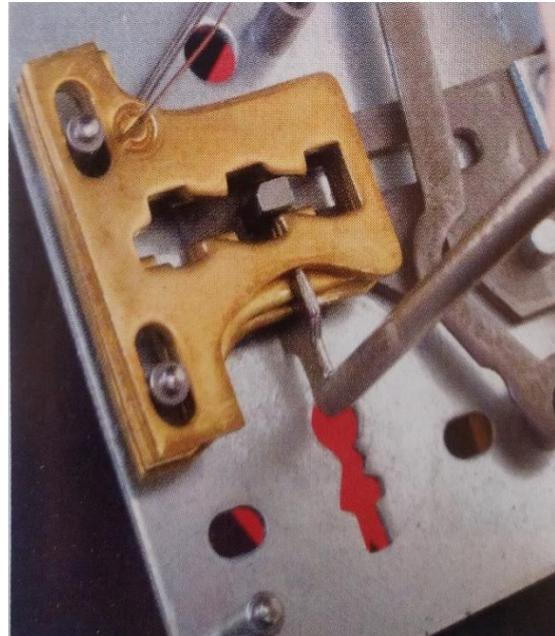
Sperrhaken einführen. Sperrzuhaltungen durch den gestuften Schlüsselbart anheben, dass der Riegel bewegt werden kann.
