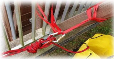
3. Belastungsprobe der Anschlagpunkte. Funktionsprüfung des Sicherungsgerätes; Hand-Off; Anti Panik
