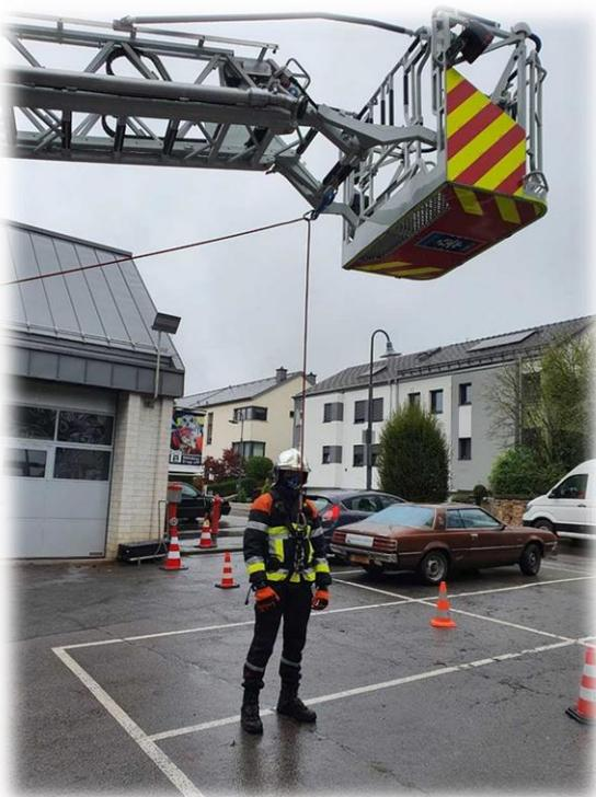
Sichern des Feuerwehrmanns über Drehkranz der Drehleiter, Umlenkung erfolgt über den Leiterpark.
