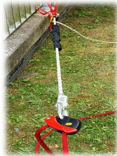
Verlagerung des Ankerpunktes mittels Grillon, Verbindungselement
