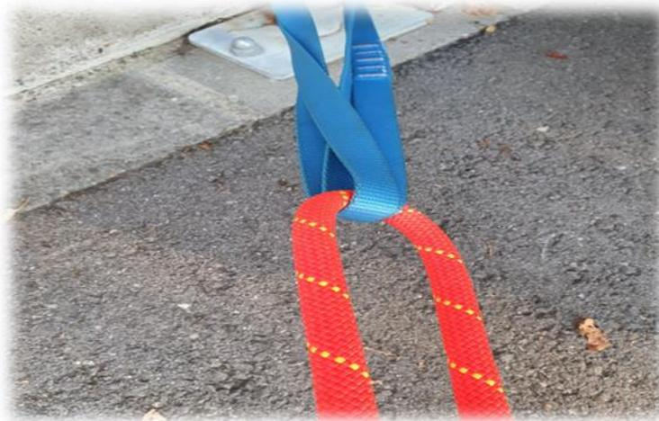
Das Seil darf niemals durch eine Rundschlinge geführt werden. Es können Schmelzverbrennungen durch die Reibung des Seils entstehen. Gefahr der thermischen Durchtrennung. Das Seil immer durch einen Karabiner führen, bzw umlenken.
