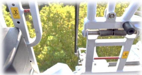
Sicherungspunkte im Drehleiterkorb, nur diese Punkte verwenden.
