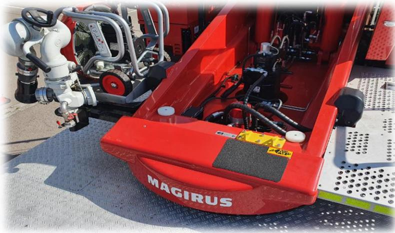
Anschlagpunkte am Drehkranz einer Drehleiter
