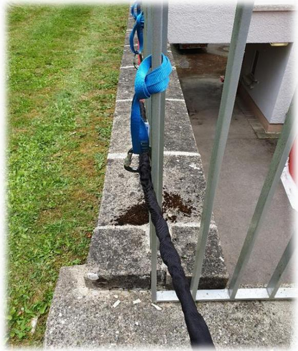
Der Verschluss der Schraubkarabiner können durch die Seilreibung geöffnet werden.
