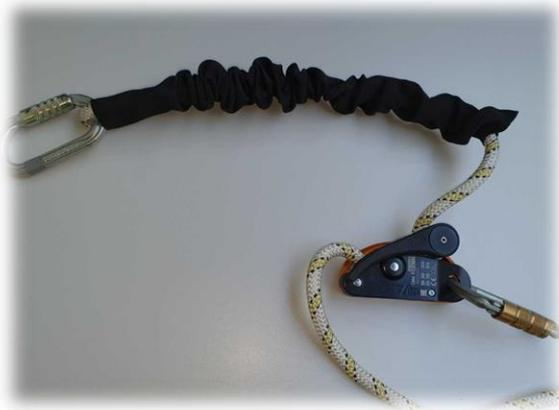
Im Drehleiterkorb erfolgt die Rückhaltung, Sicherung, Durch den **Petzl Grillon**. Dieser muss an den vom Hersteller vorgesehenen Haltepunkten fixiert werden.
