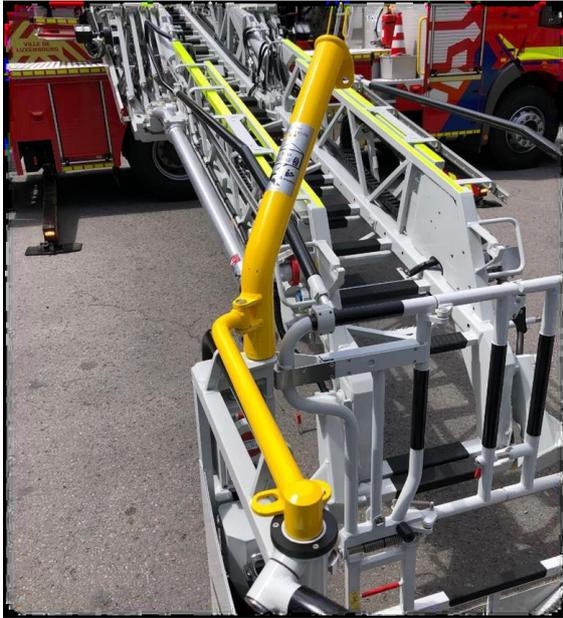
Die vom Hersteller vorgesehene Montagepunkte verwenden. Der Haltebügel ist nach hinten zum Leiterpark hin ausgerichtet.
