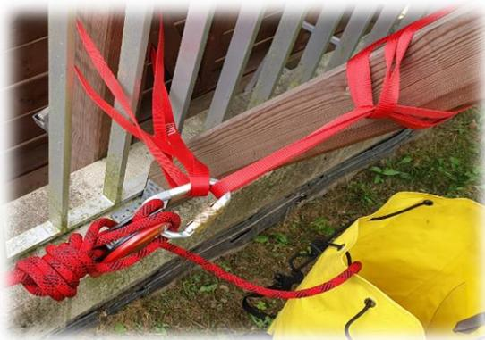
Verbindung der Anschlagpunkte mit dem Sicherungsgerat
