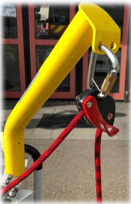
Absturzsicherung erfolgt über den Safety Peak, Haltebügel. Dieser ist vom Hersteller für die Absturzsicherung zugelassen.
