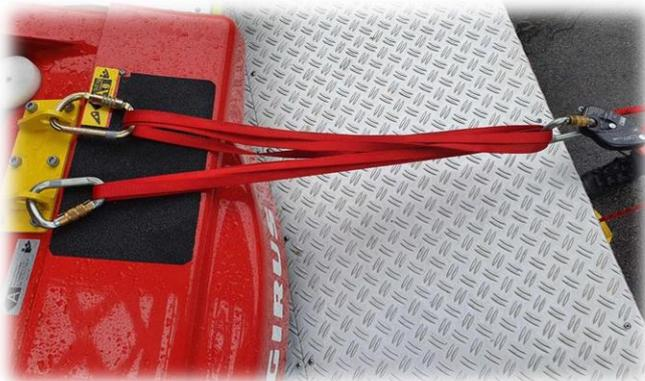
Möglichkeit zum Anschlagen des Anschlagpunkts und Verbinden mit dem Sicherungsgerät. Auch hier redundantes Anschlagverfahren.
