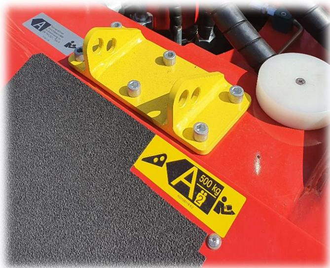
Vom Hersteller vorgesehener Anschlagpunkt mit 2 Einhängemöglichkeiten als Redundanz für Absturzsicherung, sind gelb markiert. Nutzlast des Anschlagpunkts = 500kg
