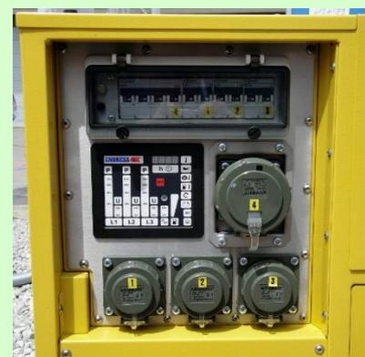
Stromaggregat 6,5kVA 1x 400V 16A & 3x 230V 16A
