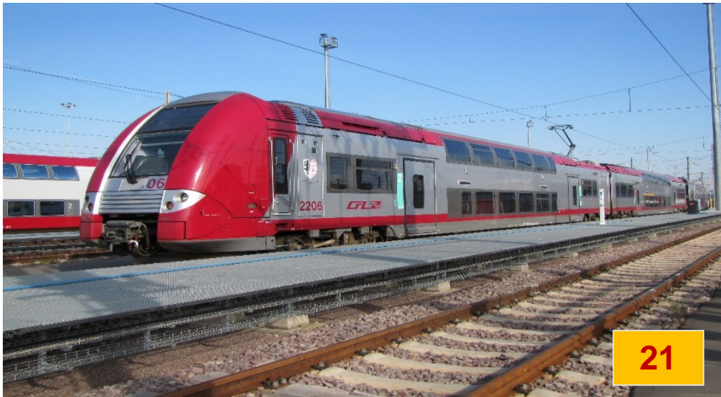
Automotrice électrique tri-caisses série 2200 (type TER2N-ng)
