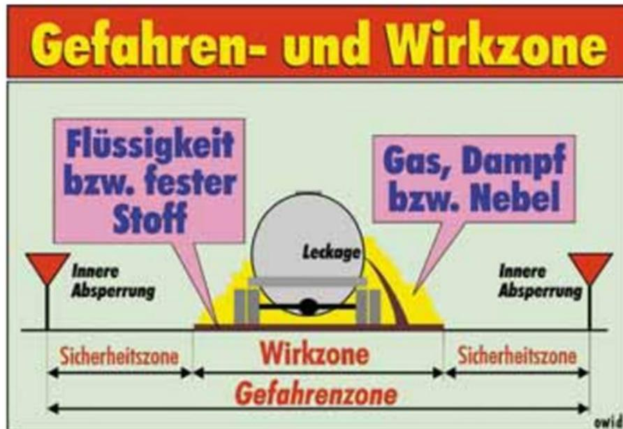
Bei explosiven Stoffen, gasförmigen Stoffen respektive entzündbaren Flüssigkeiten empfiehlt es sich die nachstehenden Abstände einzuhalten. Merke: Ein zu groß gewählter Absperrbereich kann im Einsatzverlauf verkleinert werden, ein zu klein gewählter Absperrbereich jedoch nur sehr schwer vergrößert werden.
