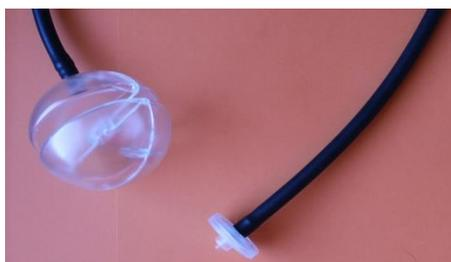
Die Schwimmsonde führt zu einer Verzögerung der Messung von min. 30 Sekunden
