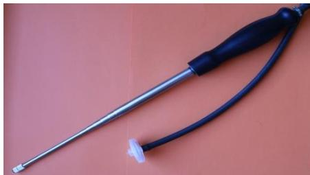
Das Spülen der Sonde durch das Ansaugen sauberer hängt von der gemessenen Konzentration ab und sollte bis zum Erreichen der 0 Werte durchgeführt werden
