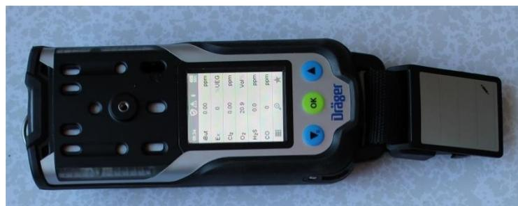
Das Multigasmessgerät ist mit 5 Sensoren bestückt, welche insgesamt über 6 Zellen verfügen. Am Fuss befinden sich ein Beschriftungsfeld und der Adapter für das Trageband oder den Standfuss. Das Messgerät ist mit Messsonden und Zubehör auf dem HLF verladen. Die gleichen Messgeräte werden vom GIS-NRBC und Einheiten der Polizei zum Einsatz gebracht.
