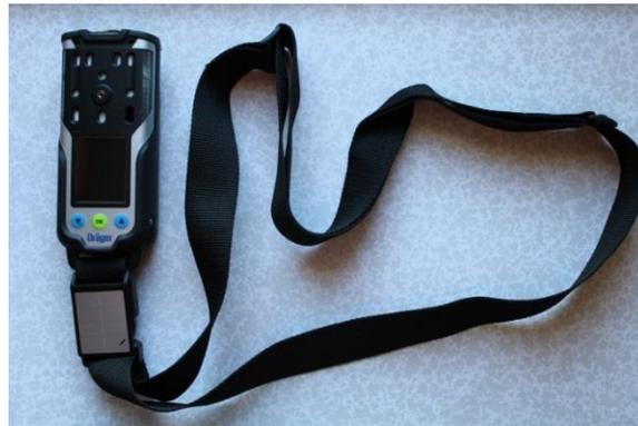
Anhand der Trageschlaufe kann das Messgerät am Körper getragen werden.
