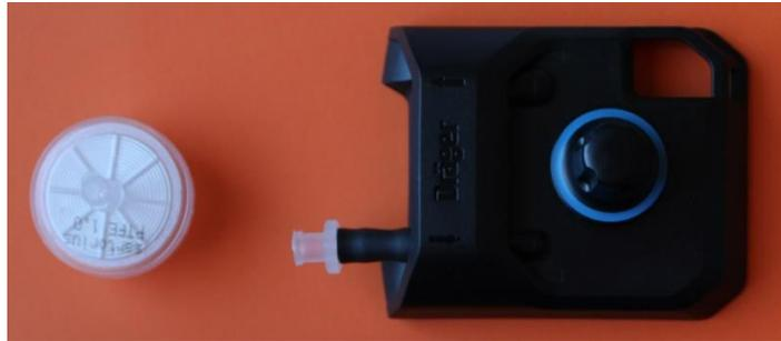
Teleskopsonde 150cm mit 100cm Schlauch ( mit Staub- und Wasserfilter)
