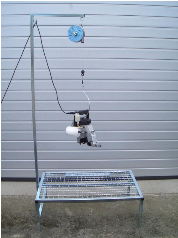
Bild 40: Modell einer Sandsacknämaschine
