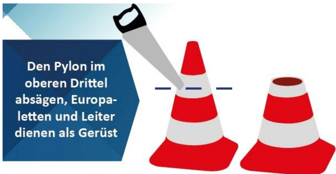
Bild 34: abgeschnittener Verkehrsleitkegel dient als Trichter
