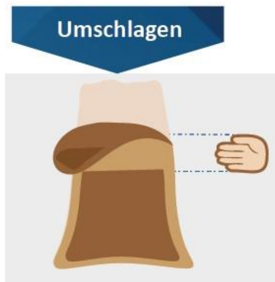
Bild 36: Umschlagen eines gefüllten Sandsackes
