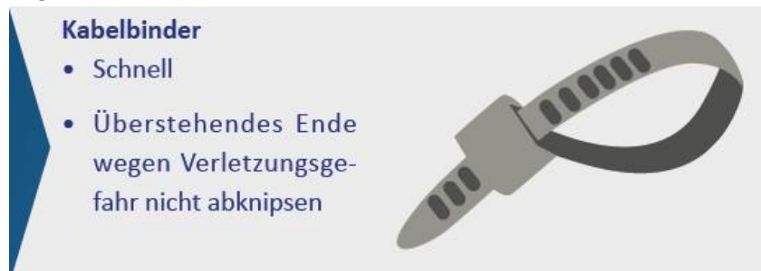
Bild 38: Verschluss mittels Kabelbinder
