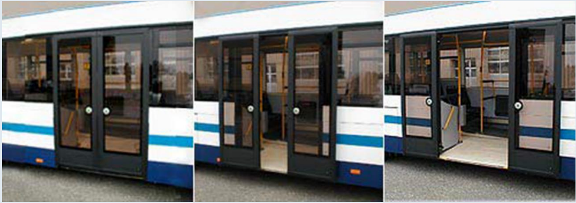
Diese Türen gehen nur minimal über die Außenmaße. Ein Gefahrenbereich ist jedoch rechts und links neben der Tür, da diese dahin fahren.
