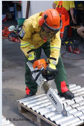
Maschine über den Drehpunkt aufrichten und eintauchen.
