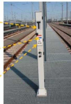
Ce type d'appareil permet la mise en communication avec les chefs de circulation des postes de desserte ou avec le Régulateur Sous-Stations (Caténaires).
