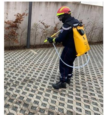
Abb. 13 Löschrucksack
