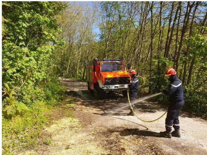
Abb. 21 Angriff Mittels Pump & Roll
