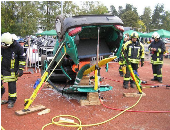
Abstützung Mittels Stab-Fast und Anheben mit Rettungszylinder
