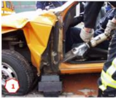
Entlastungsschnitt an der A-Säule kurz über dem Fahrzeugschweller.
