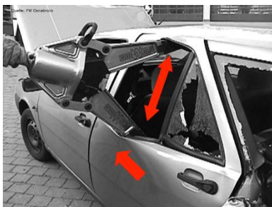
Aufspreizen der Tür an der Schlossseite
