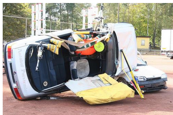
Kantenschutz und Entklemmen des Patienten mit Rettungszylinder
