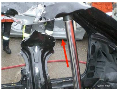
Herausreißen des Daches im Bereich der B-Säule
