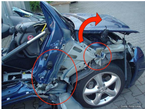
Mit Entlastungsschnitt am Motorträger
