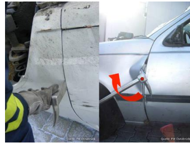
Aufspreizen an der Scharnierseite
