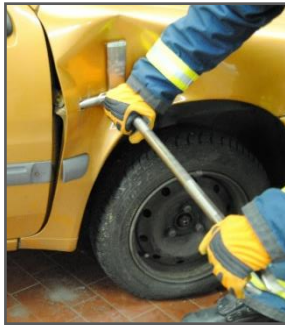
Aufspreizen der Tür an der Schlossseite
