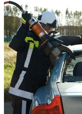
Schneiden der C-Säule
