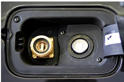
LPG Einfüllstutzen links
