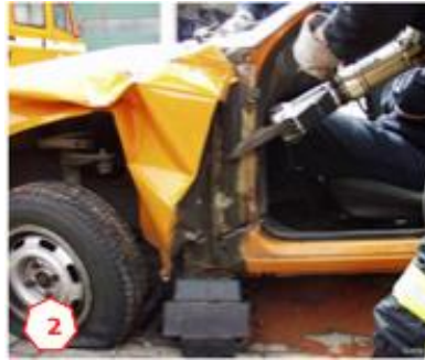
Zweiter Entlastungsschnitt an der A-Säule zirka 30cm über dem ersten Entlastungsschnitt.
