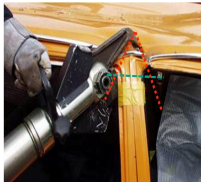
Verschiedene Schnitte zum Trennen der B-Säule
