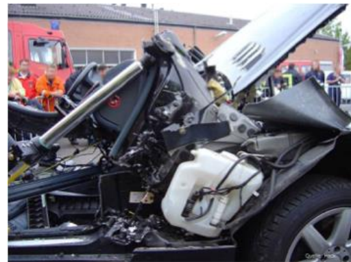
Bei modernen Fahrzeugen wird der Vorderwagen nicht gekippt sondern eher abgerissen
