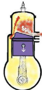
2. Takt Verbrennen, vorverdichten, Ausstoßen und Spülen
