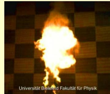
Wird das Mehl zerstäubt, kommt es zu einer Staubexplosion
