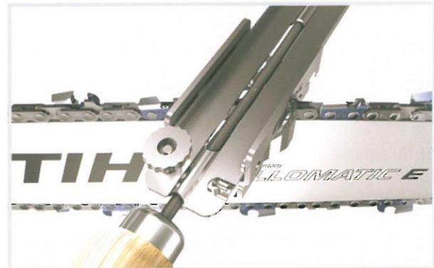
Der Feilenhalter wird durch die Feilenhalterführung seitlich geführt und im richtigen Schärfwinkel von 30° zur Führungsschiene ausgerichtet.
