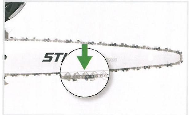
Beim Einsatz von Carving-Führungsschienen sollte die Sägekette etwas schwächer gespannt werden. Hier sollte die Hälfte der Treibglieder an der Unterseite der Führungsschiene sichtbar sein.
