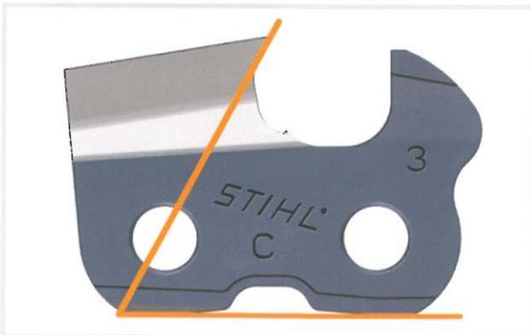
Für einen gleichmäßigen, ruhigen Lauf und eine optimale Schnittleistung der Sägekette müssen alle Schneidezähne gleich lang sein und der Schärfwinkel muss eingehalten werden.
