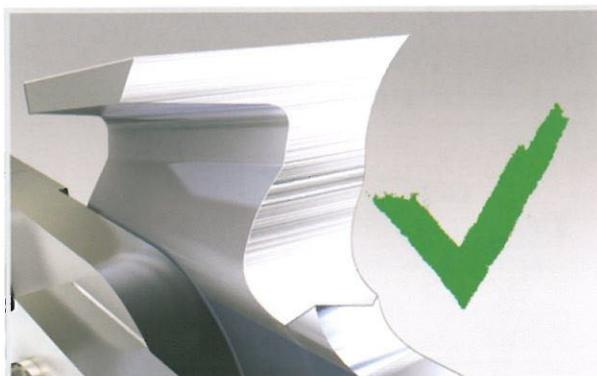
Danach feilen Sie alle Schneidezähne dieser Seite auf dieselbe Länge, dann die Motorsäge um 180° wenden und alle Schneidezähne der anderen Seite feilen. Alle Schneidezähne auf die Länge des Richtzahns bringen.
