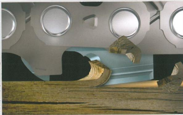
Die Schneidezähne arbeiten nach dem Hobelzahnprinzip.
