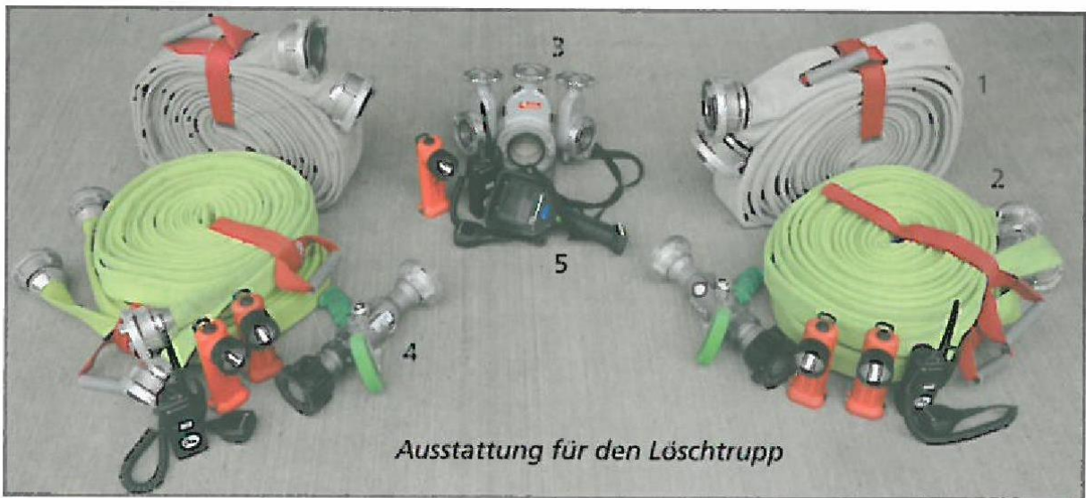
1 Transportleitung, 2 Druckleitung, 3 Teilstück, 4 Strahlrohr, 5 WBK sowie Lampen und Funkgeräte.
