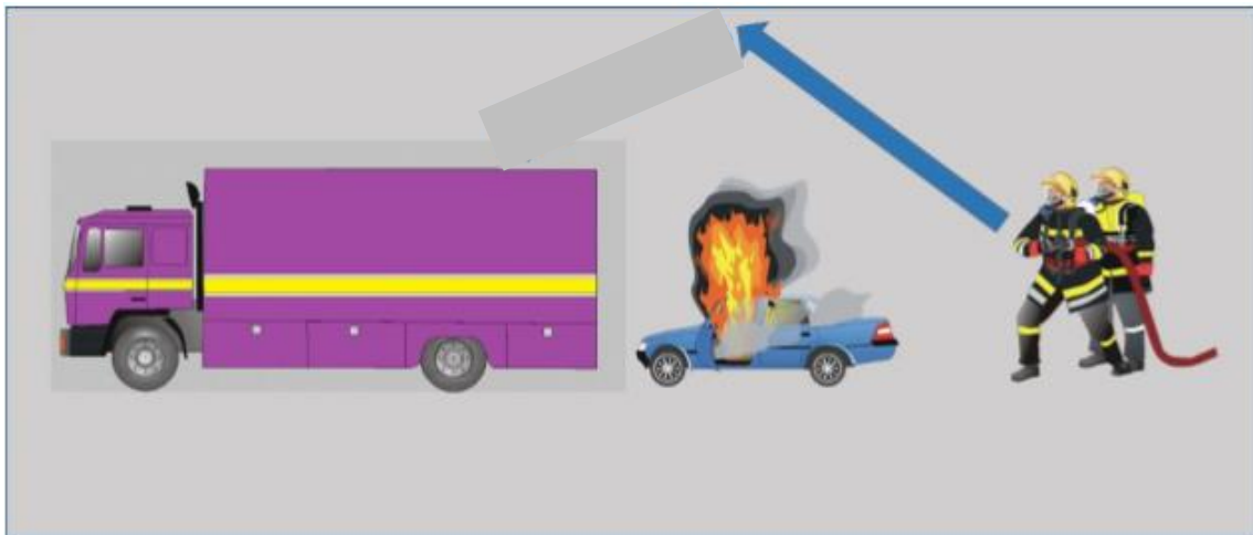
Beim Auftrag „ Strukturkühlung “ wird das Wasser an Tunneldecke und Seitenwand abgegeben.
