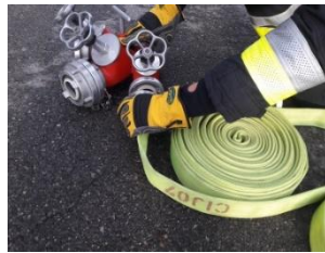
Kuppeln vom C-Schlauch an den Verteiler
