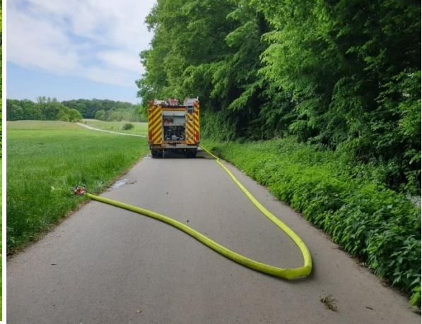
Abb. 23 Angriff mittels normalen HSR und Verteiler an der SER Brand angelehnt
