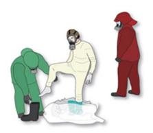
Der "Saubermann" (grün) hilft dem Anzugträger, aus den Anzugstiefeln zu steigen. Erst danach wird an einem sicheren Ort der Atemschutz abgelegt und verpackt.
