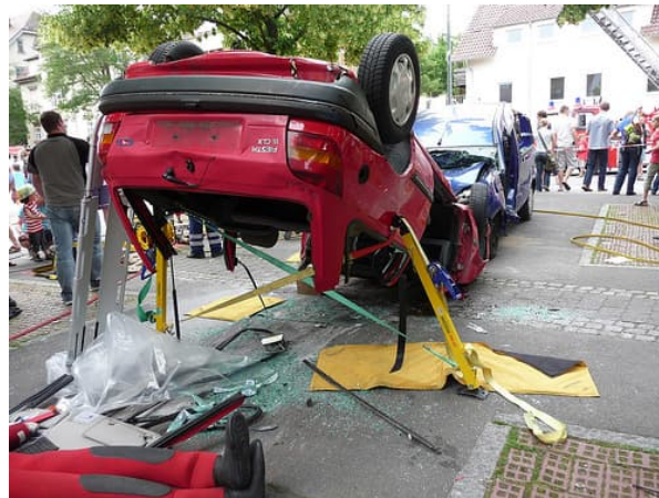
Abstützung Mittels Stab-Fast ohne Anheben mit dem Rettungszylinder sondern Abnahme des Fahrzeugdaches
