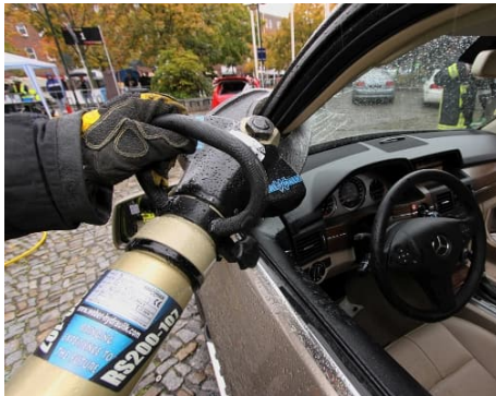
Schneiden der A-Säule
