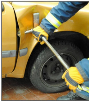
Aufspreizen der Tür an der Schlossseite
