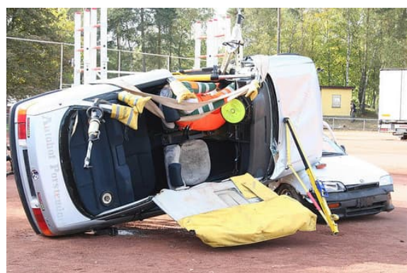
Kantenschutz und Entklemmen des Patienten mit Rettungszylinder
