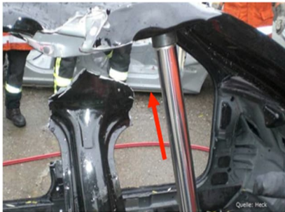
Herausreißen des Daches im Bereich der B-Säule
