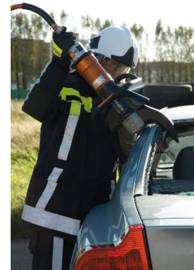
Schneiden der C-Säule
