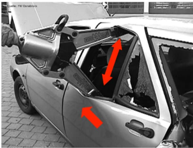
Aufspreizen der Tür an der Schlossseite
