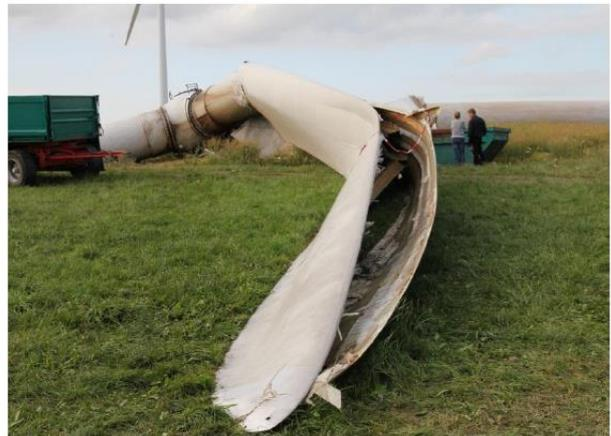
Ein Fehler an der Steuerung der Rotoren hat 2011 zu dem Umsturz eines Windrads in Kirtorf im Vogelsbergkreis geführt.
