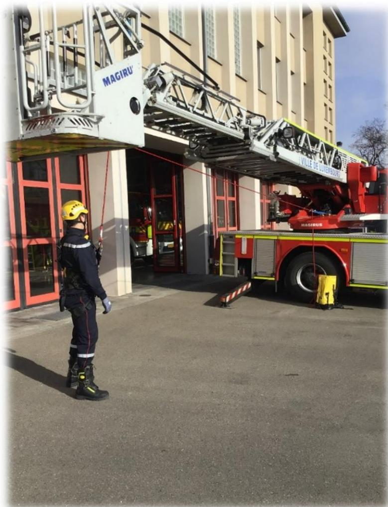
*Bild 30 : Benutzung, Sicherung vom Hauptbedienstand aus*
