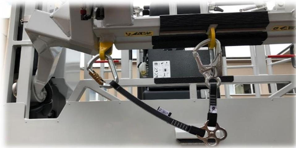
*Bild 29 : vorkonfektioniertes Gehänge, Firma Magirus*
