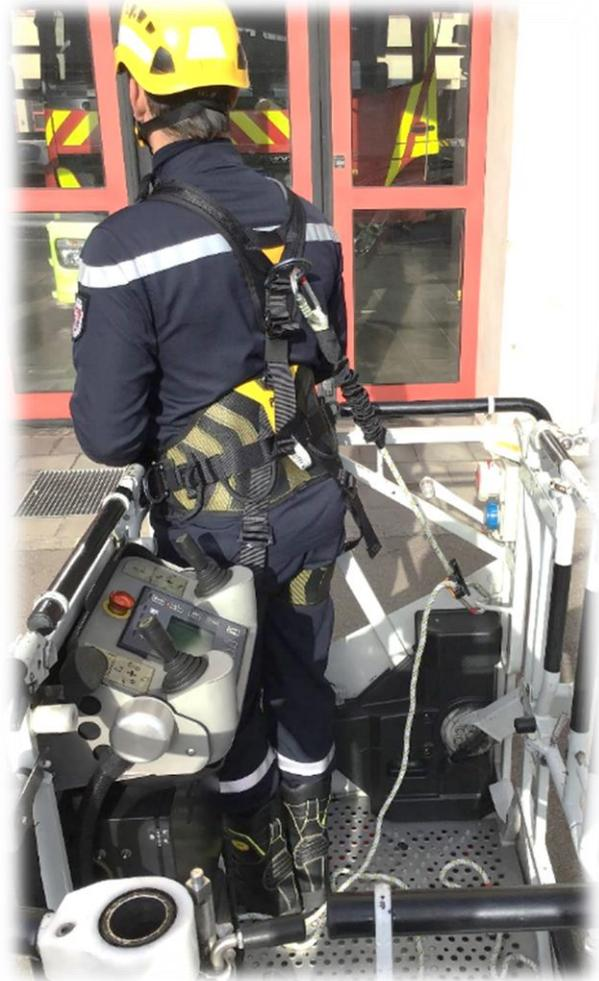
Bild 13 : Dorsal angeschlagen, Grillon wird fremd bedient
