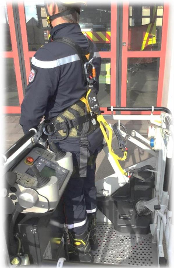
*Bild 9: Sternal angeschlagen, beide Verbindungsmittel in Sicherungspunkten eingehängt*
