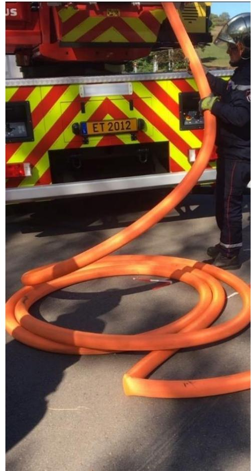
Bei Einsatzende, und wiederbestücken des Fahrzeuges, kann das B-Schlauchpaket auf die gleiche Weise gewickelt werden als das bereits bekannte C-Schlauchpaket. Auch hier kann ein Wickelbrett von Vorteil sein, und die Arbeit erleichtern.
