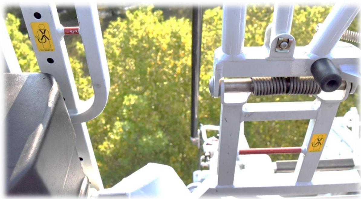
*Bild 4 : Beispiel für Sicherungspunkte im Drehleiterkorb*
