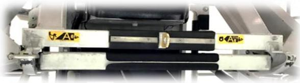
Bild 18 : geeignete Anschlagpunkte an der Drehleiterspitze
