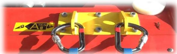
Bild 21 : geeigneter Anschlagpunkt am Hauptbedienpunkt
