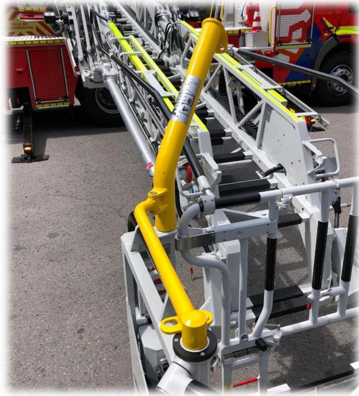
Bild 31 : Safety Peak montiert
