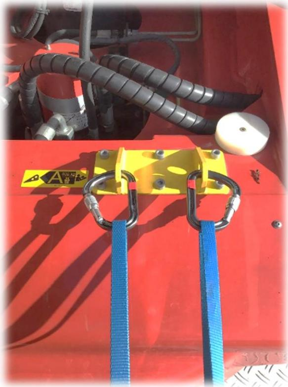
Bild 24 : Redundantes Anschlagen
