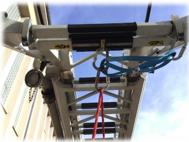
*Bild 28 : Seil vom Hauptbedienstand aus kommend einhängen und alle Karabiner verschliessen*
