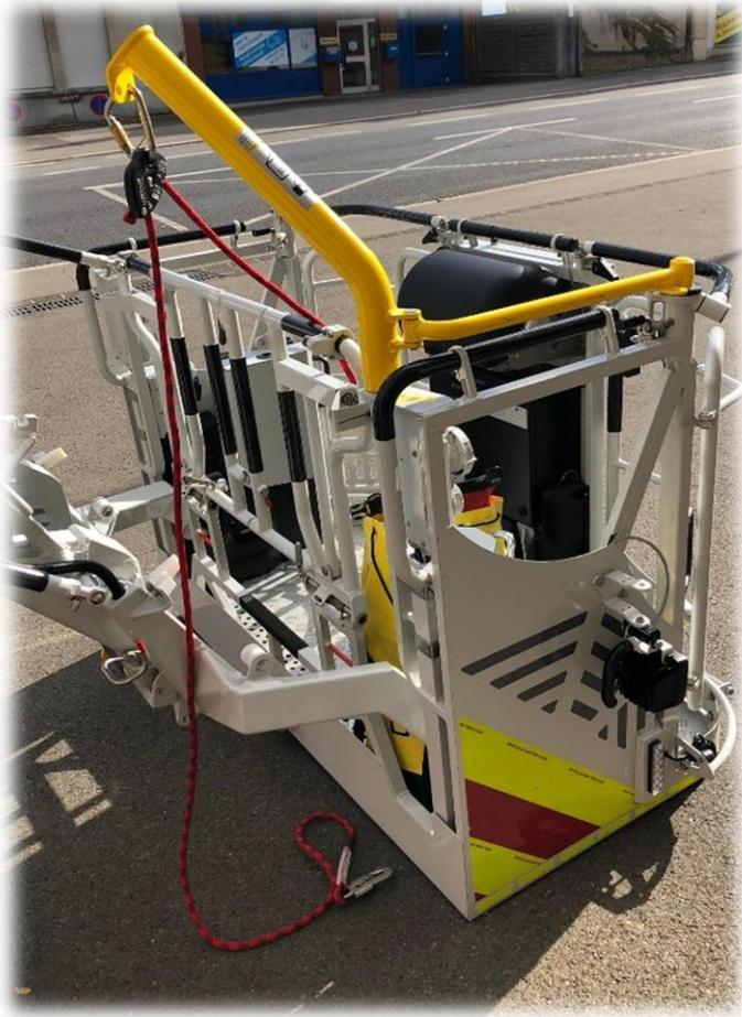
*Bild 33 : Safety Peak montiert, mit eingehängter Absturzsicherung zur Bedienung aus dem Korb heraus*
