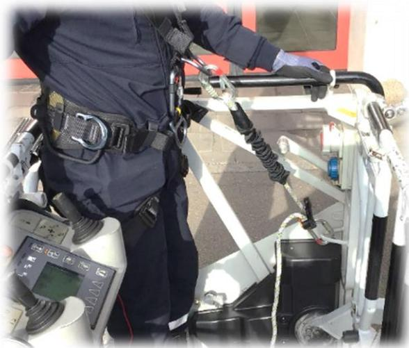
Bild 14 : Sternal angeschlagen, Grillon wird fremd bedient
