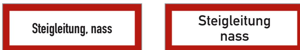
Figure 8 - Exemples de signalisation pour colonnes en charge
