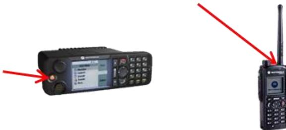
Abbildung 13 Die Notruftasten an den Funkgeräten
