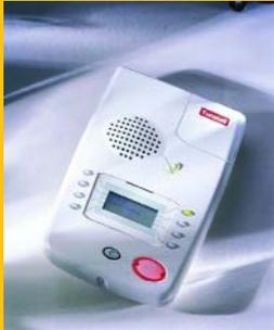
besteht aus 2 Unterteilungen. Im oberen Abteil befindet sich der Ruftaster, Lautsprecher und ein Hausnotrufgerät (PiperFon 4000+), sowie ein Akku, der den Türöffner auch im Falle
