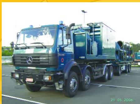
*"Hochwasserpumpe des belgischen Zvilschutzes mit einer Förderleistung von 65000 l pro Minute"*
