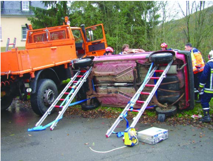
Bevor die Verletzten geborgen werden konnten, musste zunächst der Wagen stabilisiert werden.
