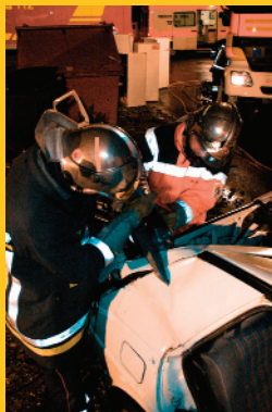
Mit der Rettungsschere wird die C-Säule des Personenwagens durchgeschnitten, um das Dach des Fahrzeuges entfernen zu können.
