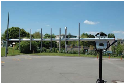
Bild: Antennen; links Yagi, rechts Stabantenne
