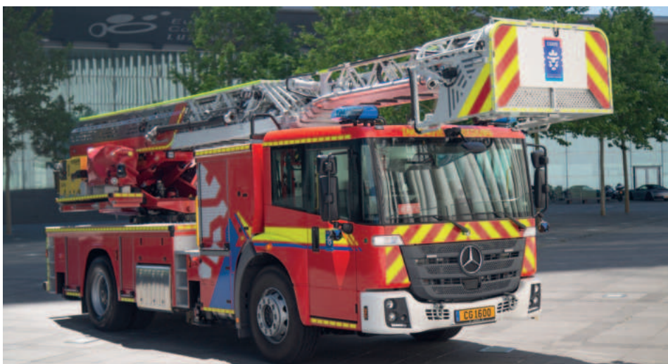
Engin de sauvetage et de travaux aériens : auto-échelle
